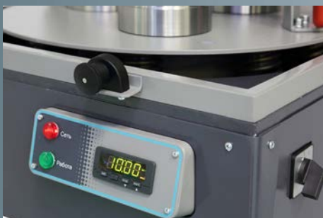
Встроенный цифровой таймер ИВ 3М
